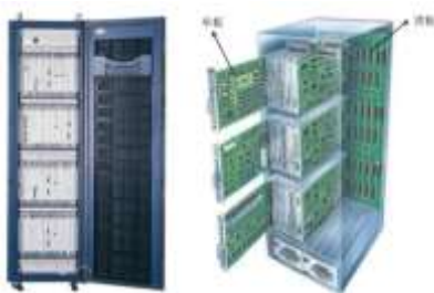
图 52: 通信基站中的背板和单板
